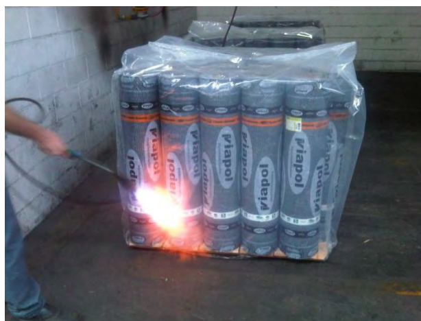
FIGURA 3 – Processo de empacotamento da Manta.
