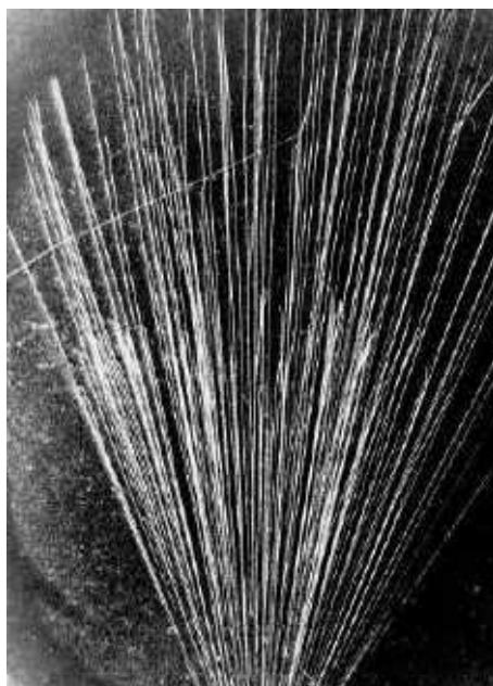
Figura 8 – Fotografia da câmara de nuvens mostrando a desintegração de um núcleo de nitrogênio ( N^{14} ) por uma partícula alfa, com a formação de oxigênio-17 ( O^{17} ) e um próton. Fonte: Retirado de Science Museum e Institute of Physics (1997). Disponível em: < http://mvc.bioweb.dcccd.edu/weblinks/images/7656.jpg >. Acesso em: 02 nov. 2013.
