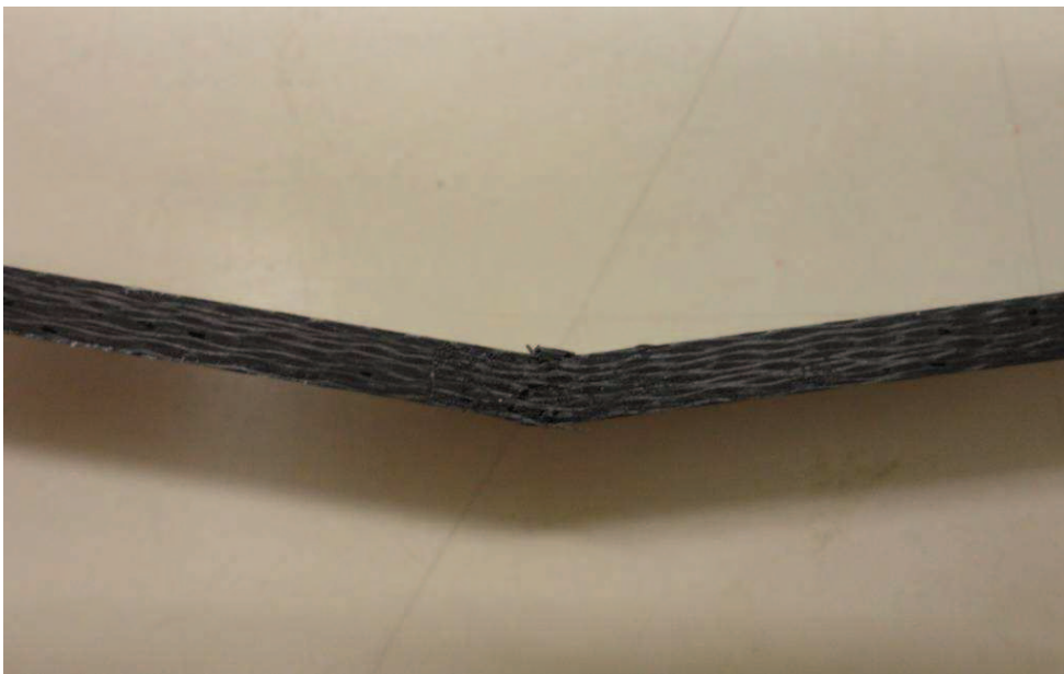
Figura 11b – Detalhe da fratura em flexão do corpo de prova.
