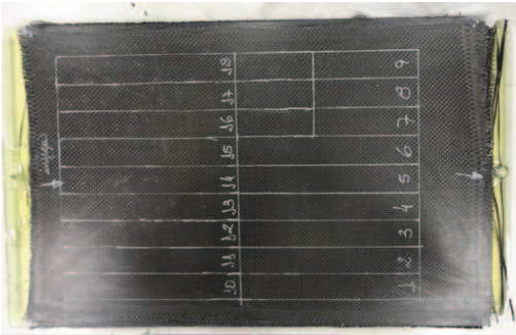
Figura 10 – Segundo compósito laminado de fibra de carbono/resina epóxi.
