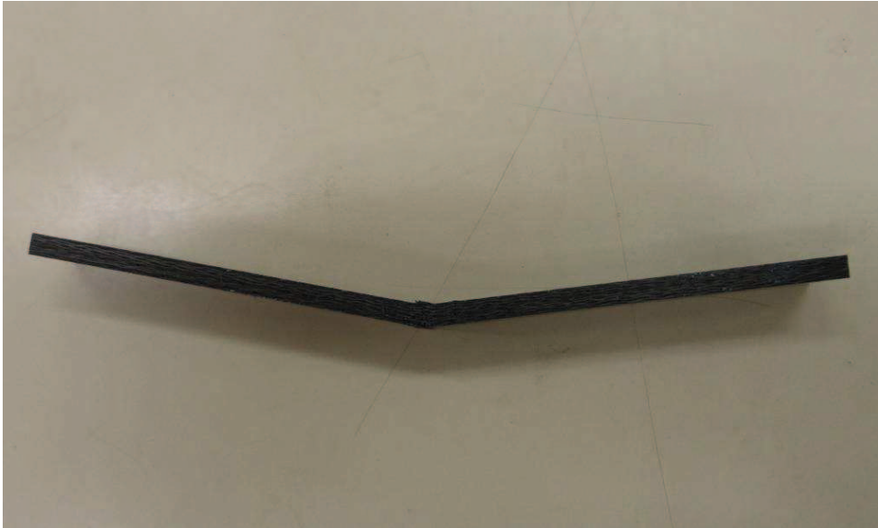
Figura 11a – Corpo de prova ensaiado em flexão.
