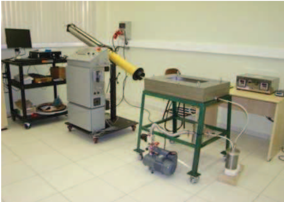
Figura 4 – Sistema de processamento de compósitos por RTM locado no DMT/FEG/UNESP.
