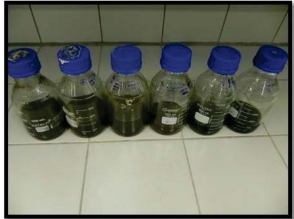
Imagem 17 – Frascos SCHOTT contendo as amostras de caule e folha em hexano e acetonitrila.
