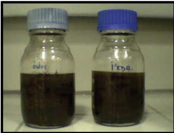
Imagem 3 – Frascos SCHOTT de 500ml contendo o material vegetal juntamente com hexano como eluente.
