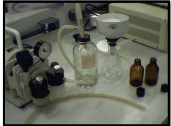
Imagem 5 – Sistema de Filtração: bomba a vácuo, kitasato, funil de Bücher, papel filtro e frascos de armazenamento.
