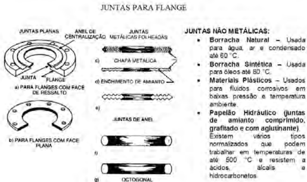
Figura 16 – Tipos de juntas para flanges. Fonte: http://dc140.4shared.com/doc/eYzaRho5/preview.html . Acesso em 13. out 2011
