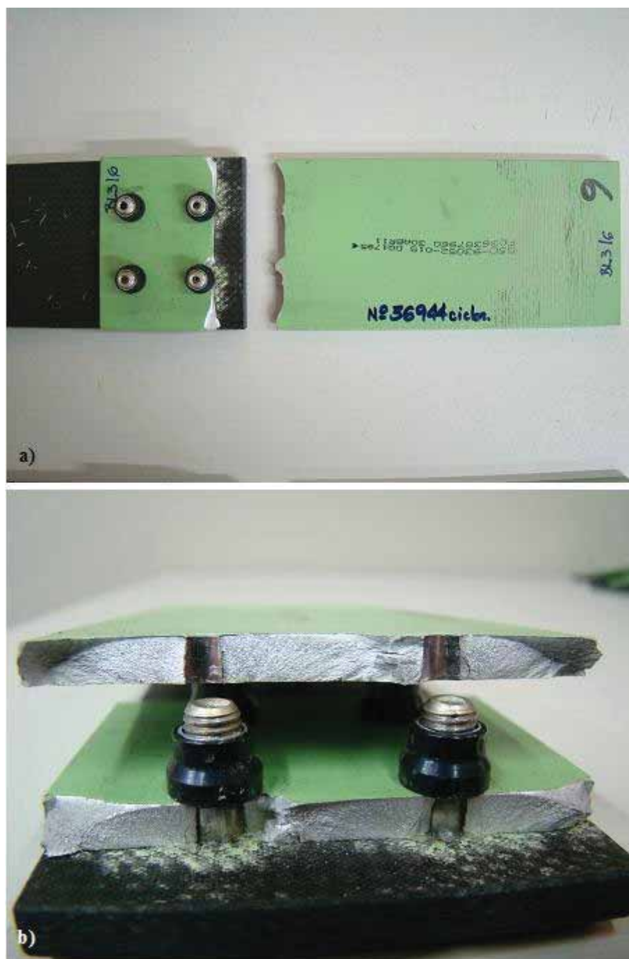
Figura 15 - CDP BL3-6 - a) região de falha; b) superfície de falha
