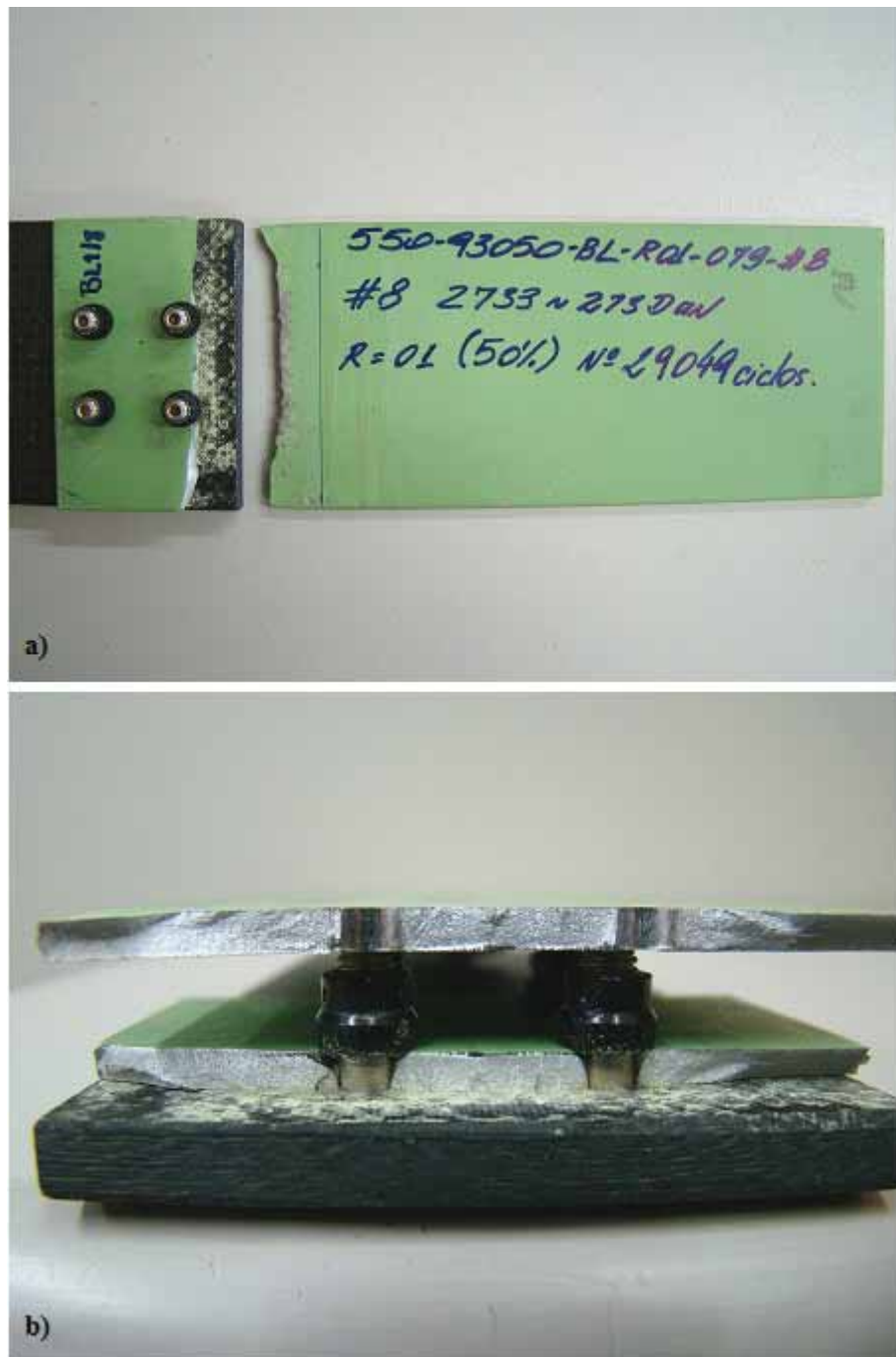
Figura 9 - CDP BL1-8 - a) região de falha; b) superfície de falha
