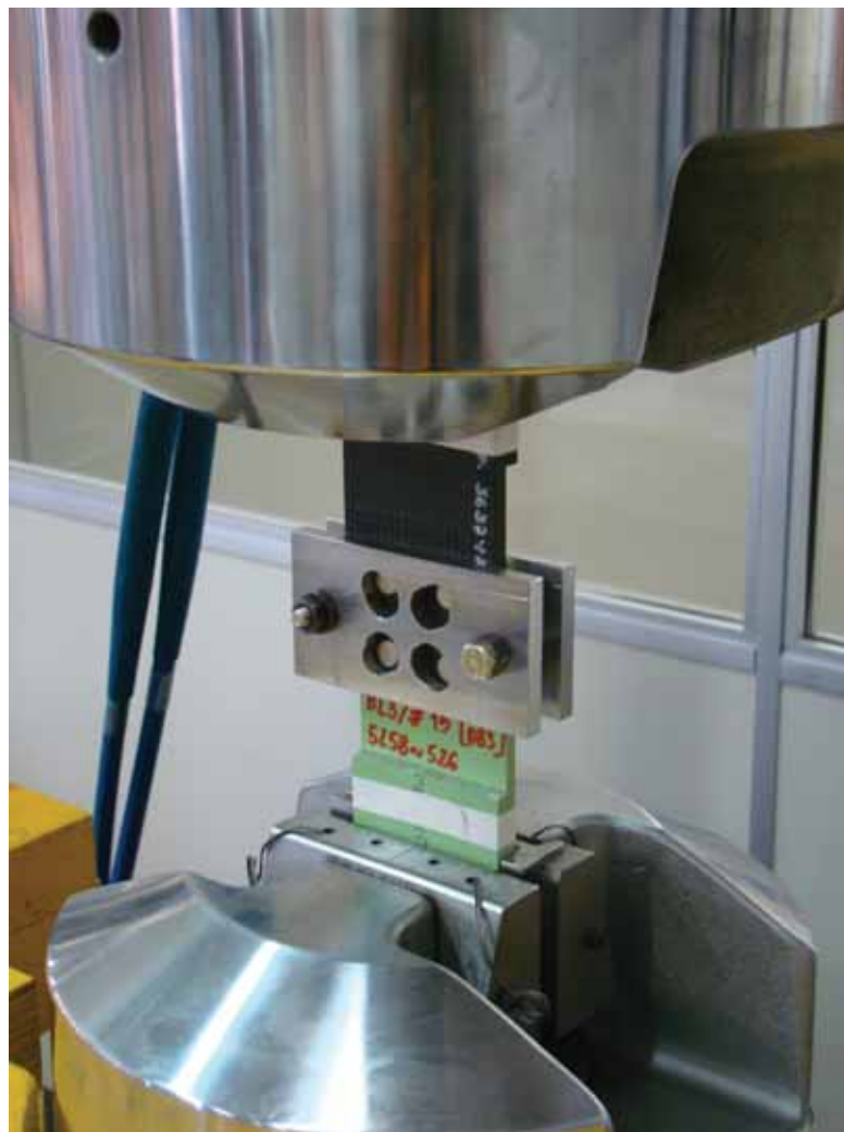
Figura 7 - Detalhe do dispositivo anti-flambagem
