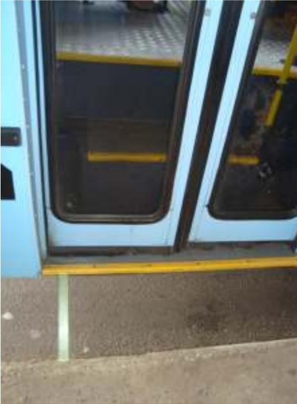
Figura 8 – Distância da plataforma na estação central
