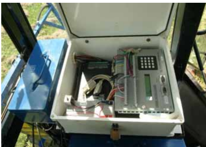
Figura 7. Sistema de aquisição de dados Micrologger CR23X.
