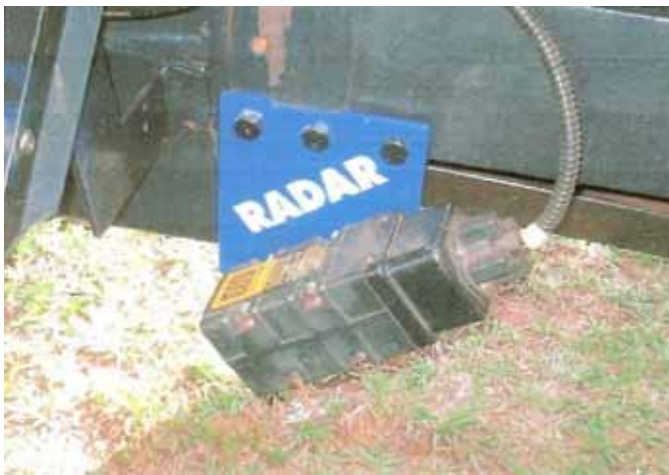
Figura 8. Unidade de radar Dickey John RVS II montado no trator.
