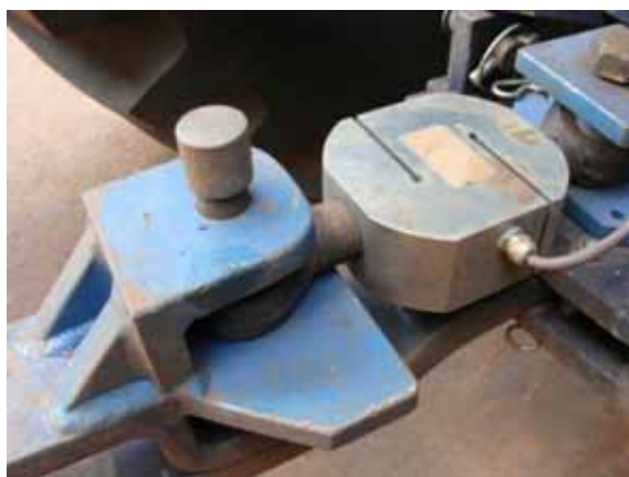
Figura 9. Célula de carga Shimizu TF 400 montada sobre o berço.
