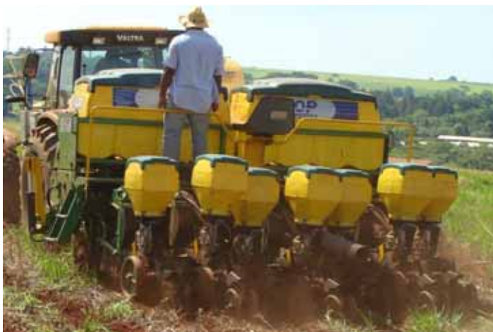
Figura 6. Semeadora-adubadora de precisão utilizada para a semeadura das culturas do milho e da soja.
