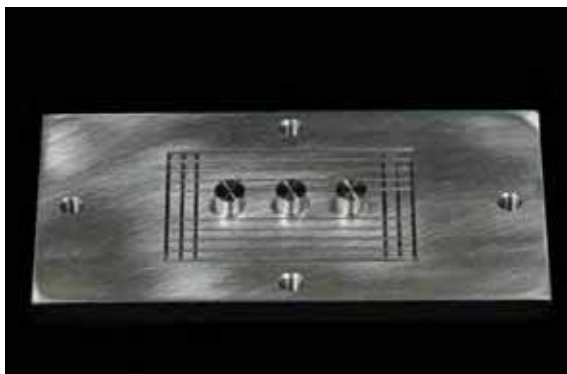
Figura 12 - Componente 1 da matriz utilizada para obtenção dos padrões em resina .
