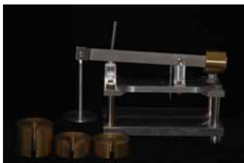
Figura 20 - Dispositivo de aplicação de carga (DAC).
