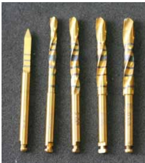
Figura 2 - Fresas helicoidais utilizadas nas perfurações: lança; 2,0 mm; 2,5 mm; 2,8 mm e 3,2 mm.
