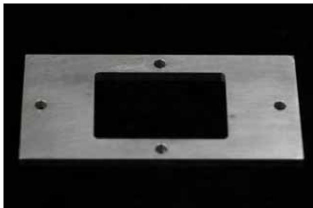
Figura 13 - Componente 2 da matriz utilizada para obtenção dos padrões em resina .
