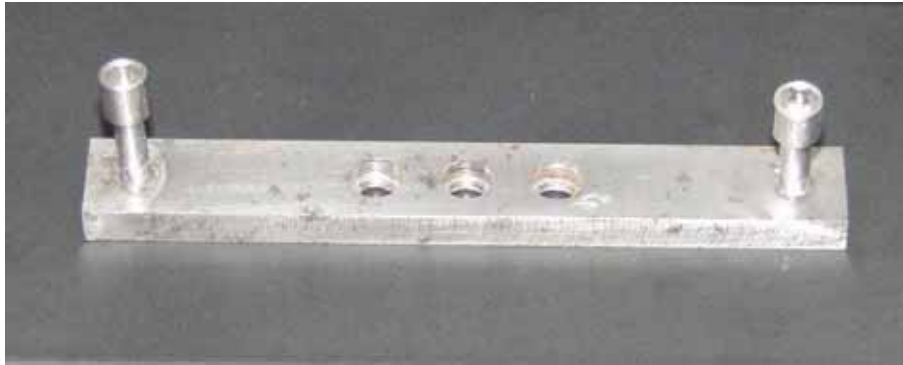
Figura 3 - Matriz para padronização das perfurações perpendiculares com os adaptadores posicionados.
