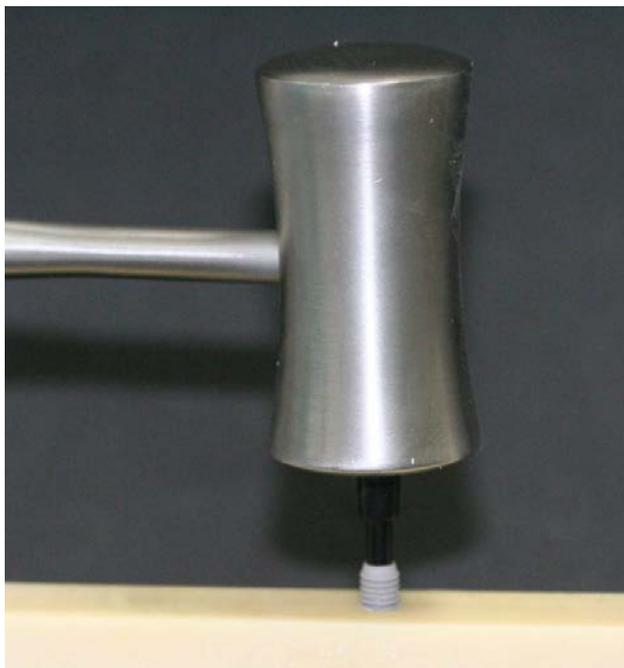
Figura 13 – Inserção do implante no bloco de poliuretano.
