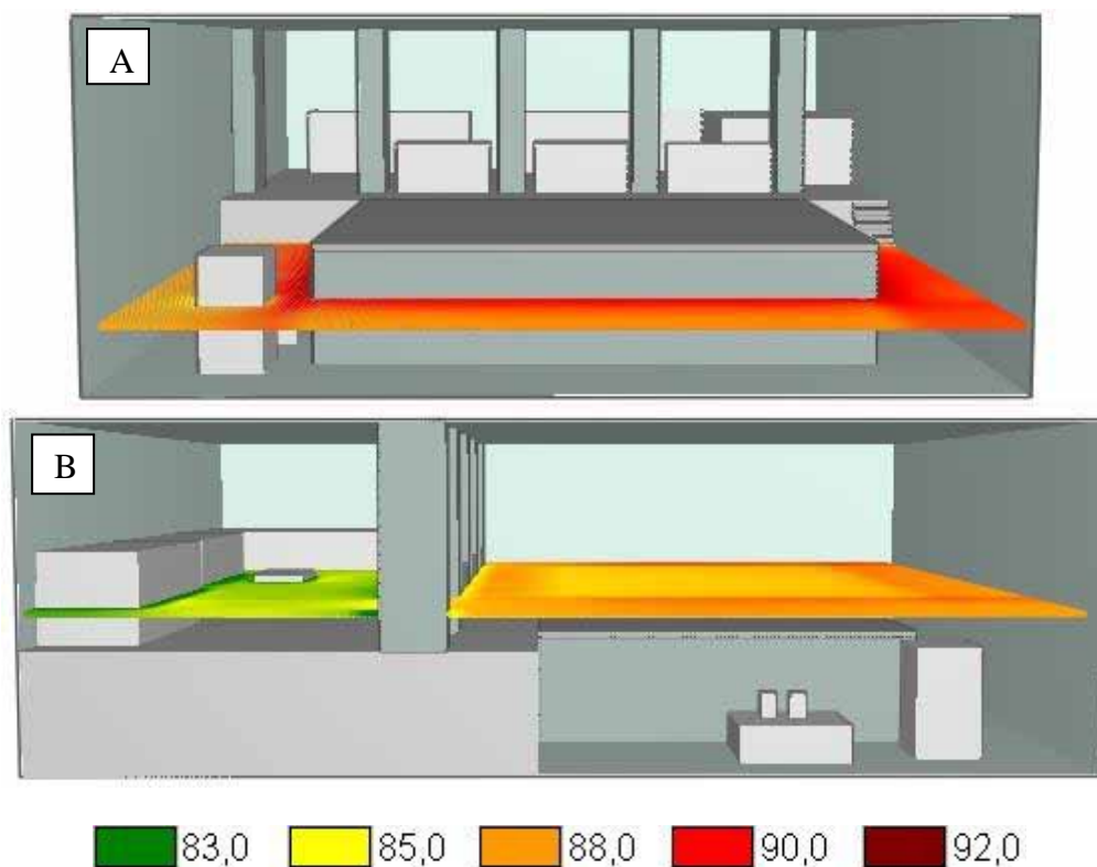
Figura 36 – Mapa acústico em um: A) plano em uma altura de 2m na perspectiva frontal e B) plano em uma altura de 5m na perspectiva lateral direita
