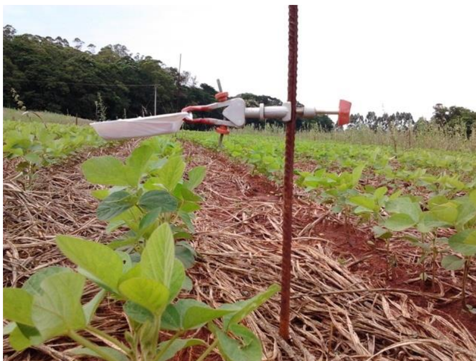
Figura 4. Coletor de N- \text{NH}_3 instalado sobre plantas de soja.
