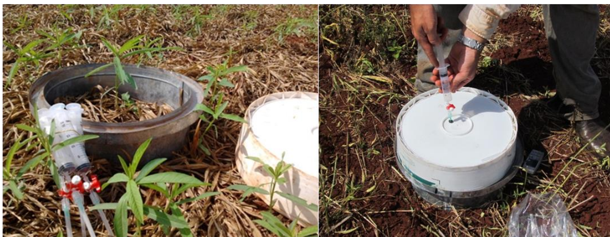
Figura 6. Detalhe das seringas e da câmara utilizada na coleta (a) e do momento da coleta (b).
