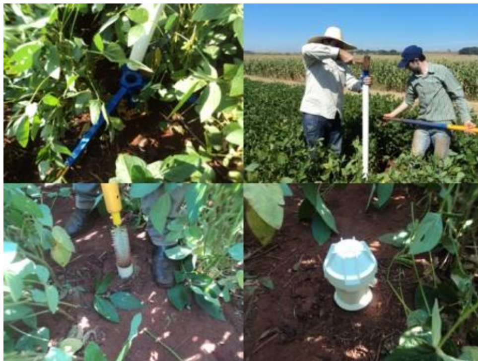
Figura 2. Detalhes da instalação dos tubos de acesso.
