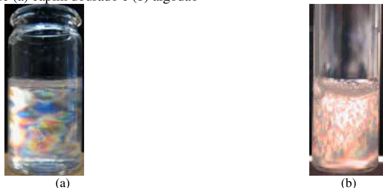
Figura 3.12 - Imagens de domínios birrefringentes presentes em suspensões aquosas de whiskers de celulose obtidos de (a) capim dourado e (b) algodão
