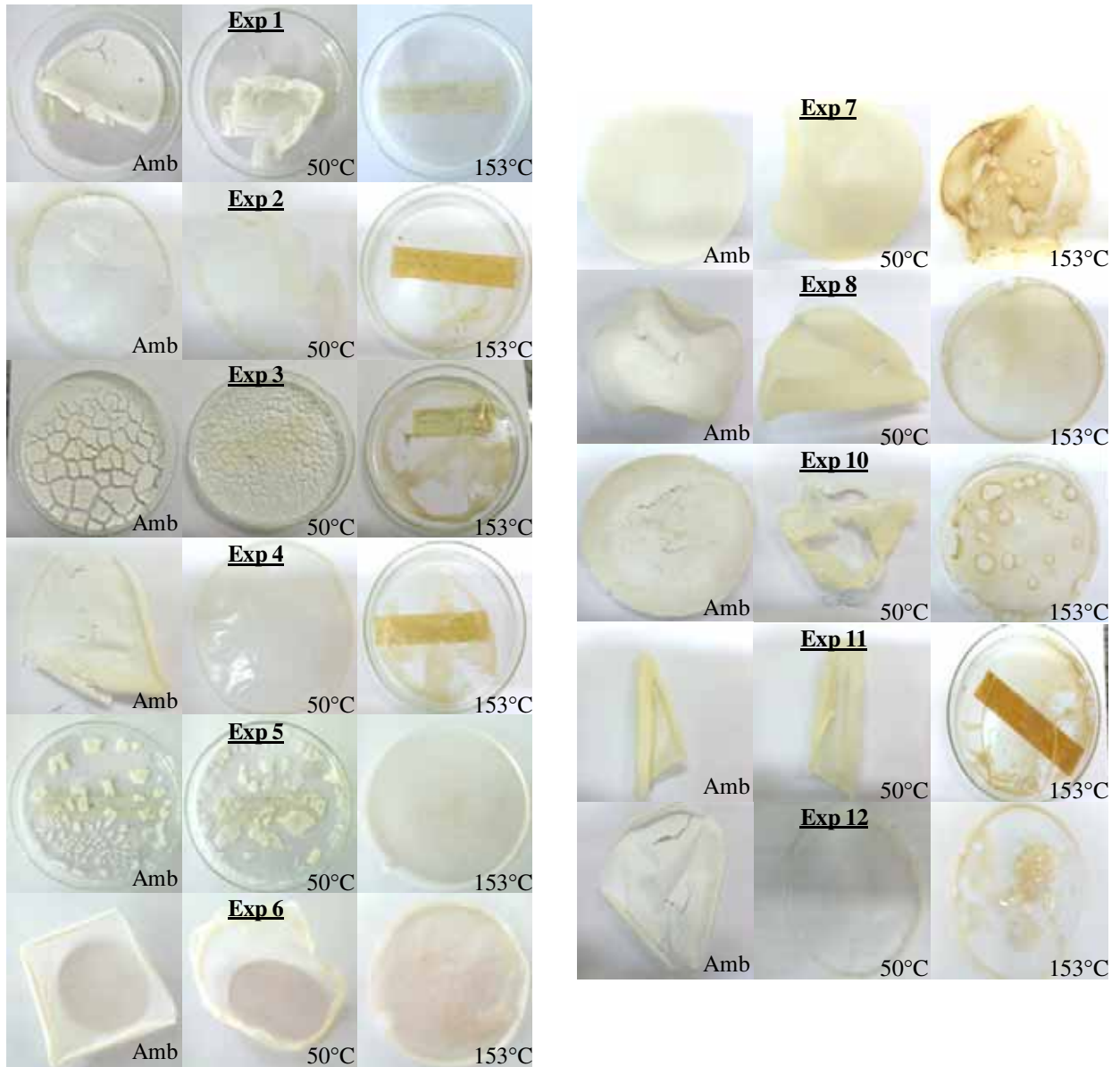
Figura 6.28 - Filmes de PHBV obtidos por casting e solubilizados seguindo o PE
