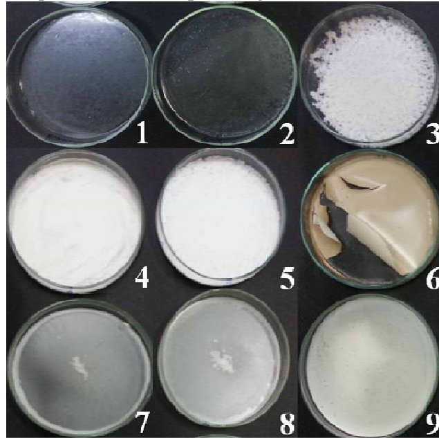
Figura 6.3 - Imagens das suspensões de NCC após secagem em estufa convencional
