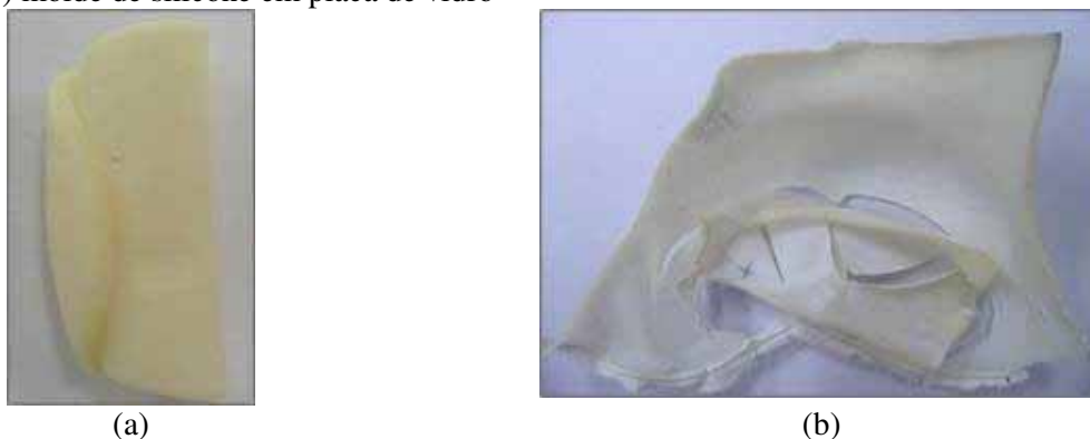
Figura 4B - Filmes obtidos por casting da solução 6, secos a temperatura ambiente em (a) placa de petri e (b) molde de silicone em placa de vidro
