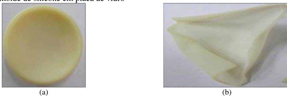
Figura 5B - Filmes obtidos por casting da solução 7, secos a temperatura ambiente em (a) placa de petri e (b) molde de silicone em placa de vidro
