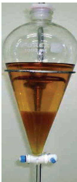
Figura 27.12 – Processo de decantação do óleo de soja degomado com metóxido de sódio Fonte: Dib (2010)
