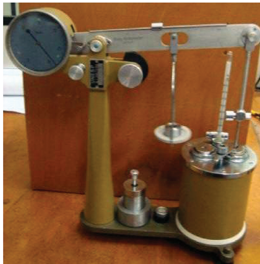
Figura 27.24 – Equipamento utilizado para determinação da viscosidade Fonte: Dib (2010)
