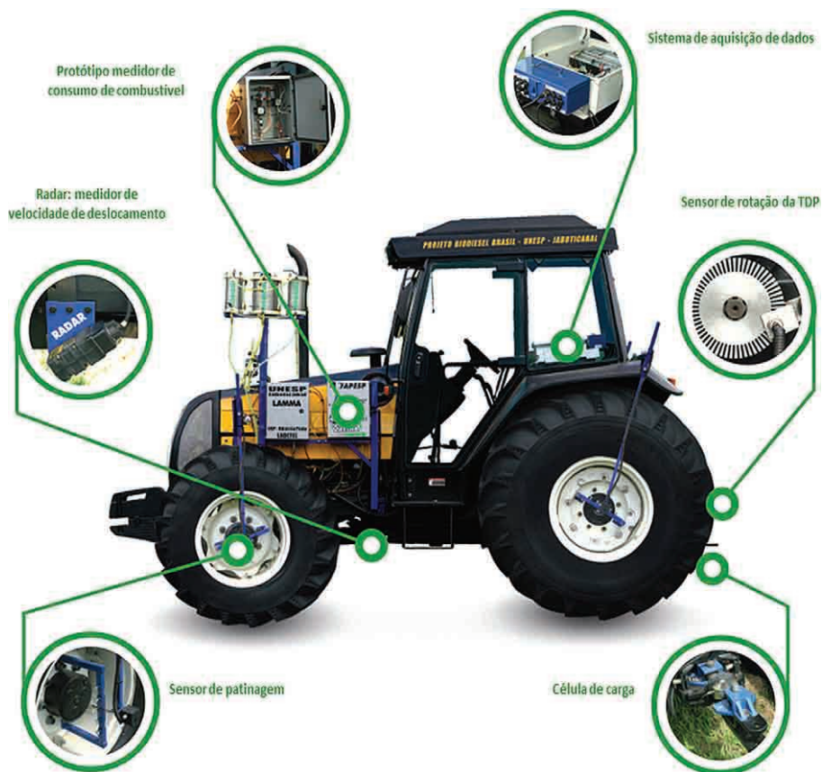
Figura 13.7 – Vista geral do trator de ensaio com instrumentação completa
