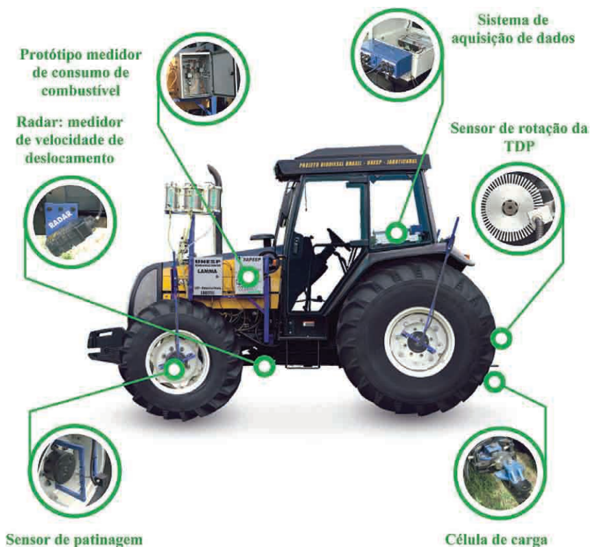
Figura 15.6 – Vista geral do trator de ensaio com instrumentação completa.
