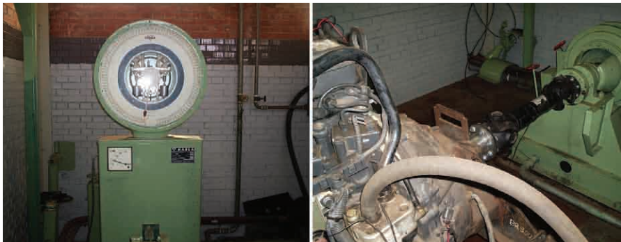
Figura 15.5 – Dinamômetro acoplado ao motor MB OM 924 LA.
