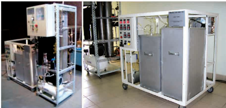
Figura 17.3 – Reformador de etanol: protótipo II
