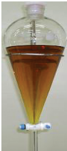
Figura 27.19 – Final da decantação do óleo de soja degomado transesterificado por rota etílica Fonte: Dib (2010)
