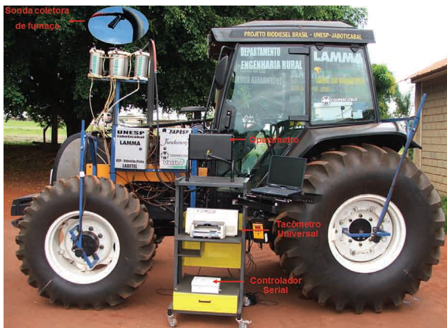
Figura 13.8 – Vista geral do trator instrumentado para o ensaio de opacidade da fumaça.
