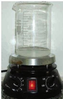
Figura 27.10 – Processo de formação do metóxido de sódio
