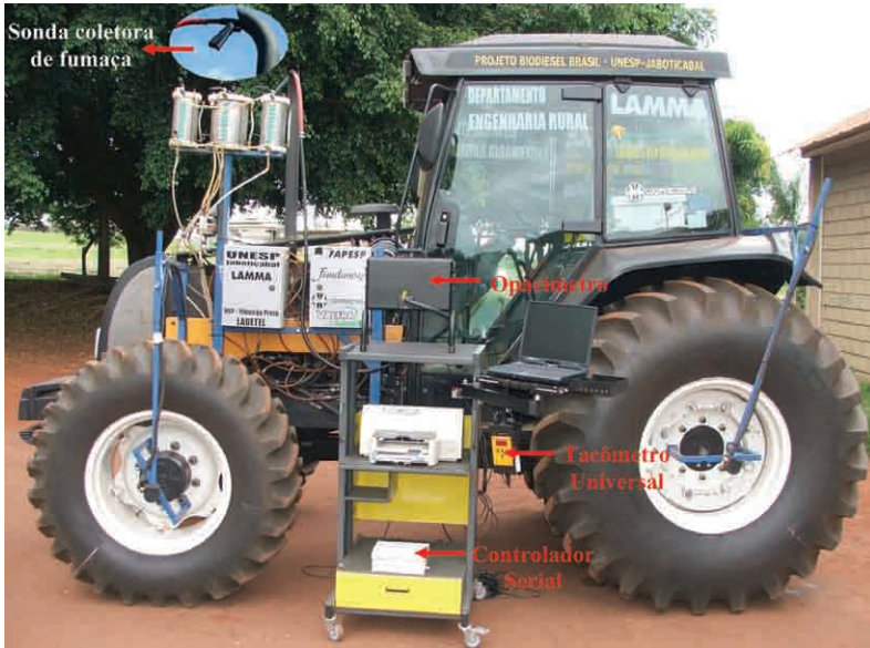
Figura 15.7 – Vista geral do trator instrumentado para o ensaio de opacidade da fumaça.
