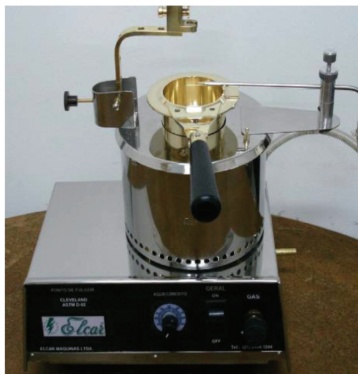
Figura 27.25 – Equipamento utilizado para determinação do ponto de fulgor Fonte: Dib (2010)
