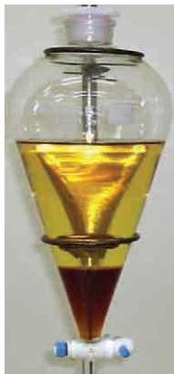
Figura 27.16 – Processo de decantação de fritura pré-tratado e metóxido de sódio
