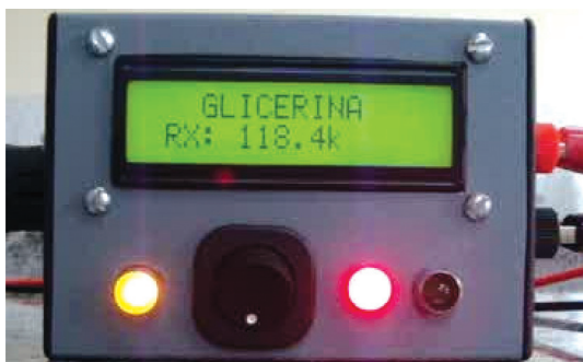
Figura 27.37 – Visor de LCD com informações da glicerina
