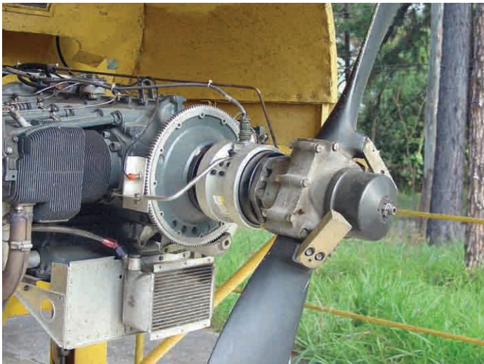
Figura 17.11 – Visão geral da bancada de testes com motor Lycoming IO-540 (IAE).
