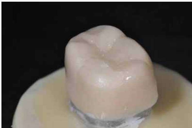
Figura 24 – Modo de falha (lascamento da porcelana de cobertura) dos corpos de prova (nesse caso, o lascamento ocorreu na cúspide disto-lingual, onde se aplicou a carga do grupo CD).
