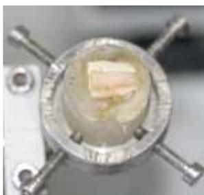
Figura 8 – Amostra pronta para início da fase de corte e preparação de palitos.
