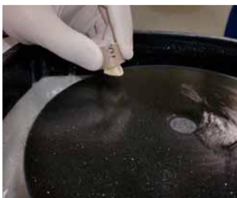
Figura 5 – Planificação e regularização da superfície dentinária.
