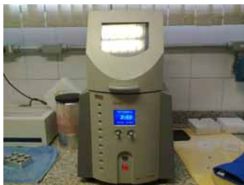
Figura 4. Moinho criogênico Spex 6700-230 freezer/mill – Spex Industries, Edison, Estados Unidos.
