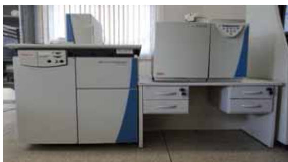
Figura 6. Espectrômetro de massa de razões isotópicas Delta S – Finnigan MAT, Bremen, Alemanha do CIE.
