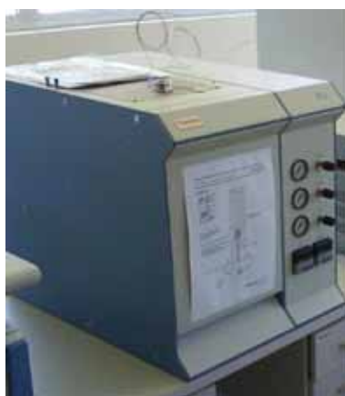
Figura 7. Espectrômetro de massa de razões isotópicas Thermo Finnigan TC/EA-IRMS, Bremen, Alemanha do CIE.
