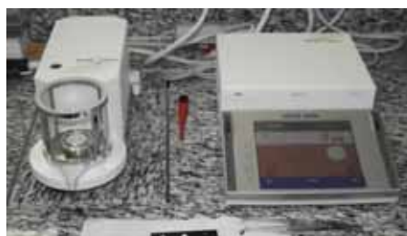
Figura 5. Balança de alta precisão Excellence Plus Balance XP6 – Metler Toledo International Inc.
