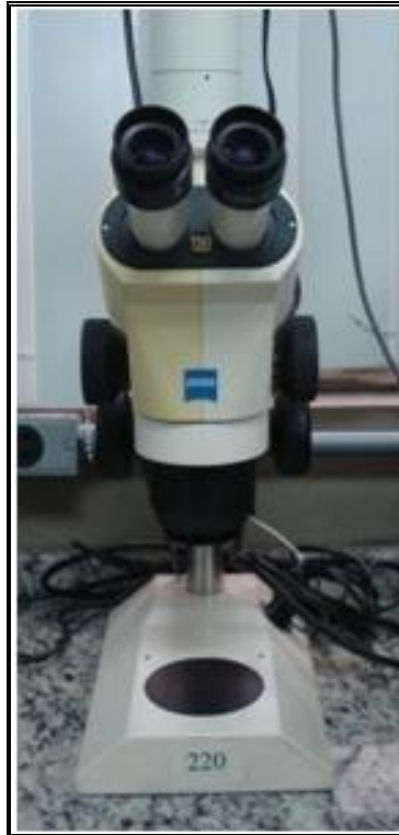
Figura 8 - Estereomicroscópio óptico - Karl Zeiss/ Stemi 2000C-MC-80-DX.
