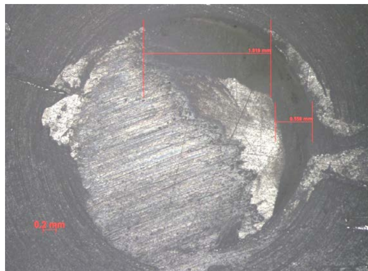
Figura 65 - Amostra 2; falha mista, 1/3 < \text{cimento resinoso} < 2/3 da área adesiva.
