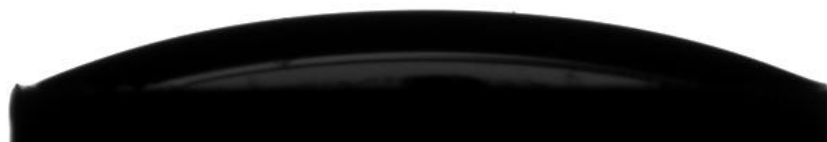
Figura 41 - Ângulo de Contato de 11,2° apresentado pela Zircônia jateada com micropartículas de óxido de alumínio revestido por sílica.
