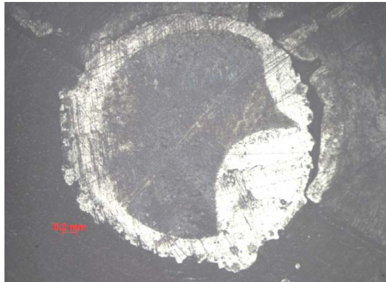
Figura 66 - Amostra 1; falha adesiva, área adesiva apresenta ausência de cimento resinoso.
