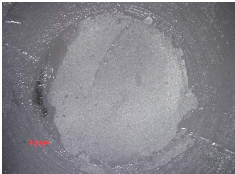
Figura 68 - Amostra 2; falha adesiva, presença de cimento resinoso < 1/3 da área adesiva.
