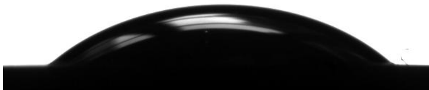
Figura 42 - Ângulo de Contato de 22,3° apresentado pela Zircônia revestida por nanofilme à base de sílica.
