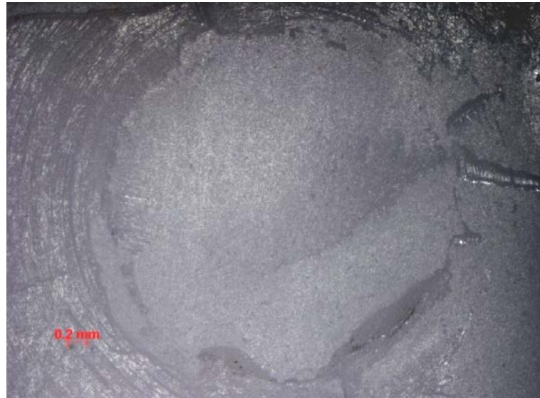
Figura 69 - Amostra 6; falha adesiva, presença de cimento resinoso < 1/3 da área adesiva.
