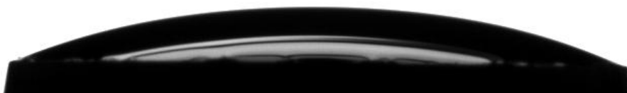
Figura 43 - Ângulo de Contato de 12,5° apresentado pela Zircônia jateada com micropartículas de óxido de alumínio e revestida por nanofilme à base de sílica.
