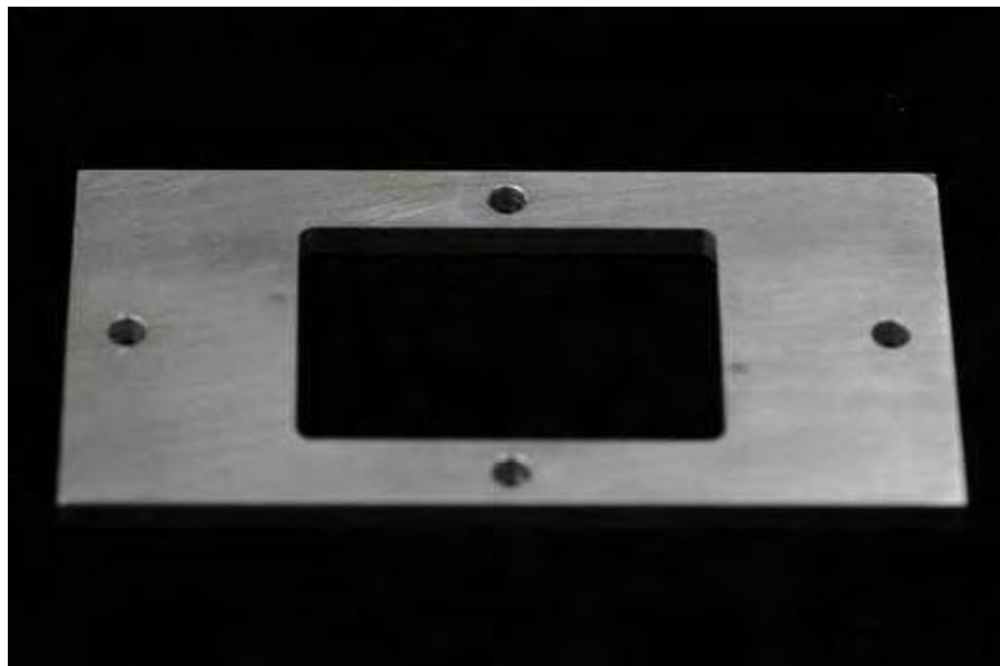
Figura 14 - Componente 2 da matriz utilizada para obtenção dos padrões em resina .
