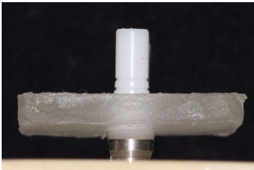
Figura 15 - Estrutura em resina acrílica posicionada nas coifas plásticas.
