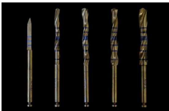
Figura 3 - Ponta de lança e as fresas helicoidais utilizadas nas perfurações: 2,0 mm; 2,5 mm; 2,8 mm e 3,2 mm.
