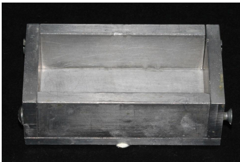
Figura 2 - Matriz para confecção do bloco de poliuretano montada.
