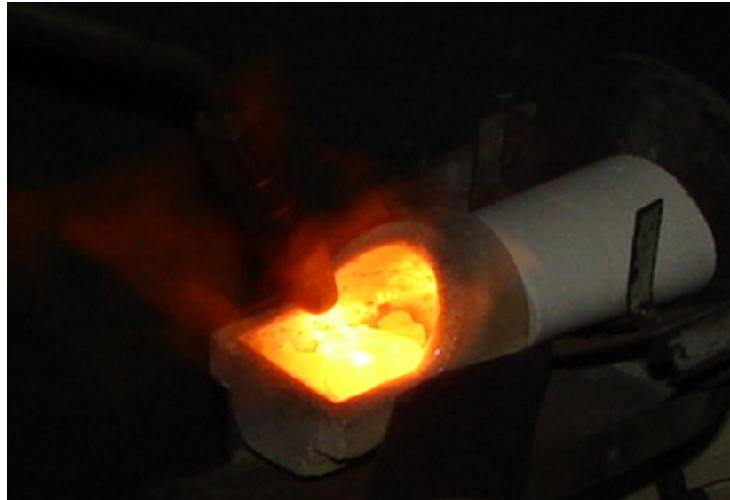
Figura 17 - Realização da fundição em centrífuga convencional.
