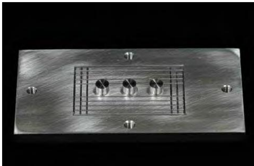
Figura 13 - Componente 1 da matriz utilizada para obtenção dos padrões em resina .
