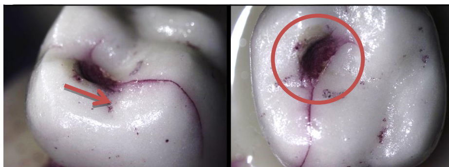
Figura 15 – Imagem representativa do modo de falha (trinca) de uma coroa após o teste de fadiga deslizante. (A) A seta indica o sentido do movimento deslizante de vestibular para lingual. (B) Extensão da zona de dano causa pela ponta aplicadora de carga.
