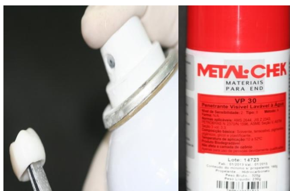
Figura 11- Aplicação do líquido evidenciador de trinca Metal Chek .
