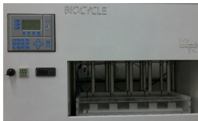
Figura 13 - Simulador de ciclos mastigatórios.
