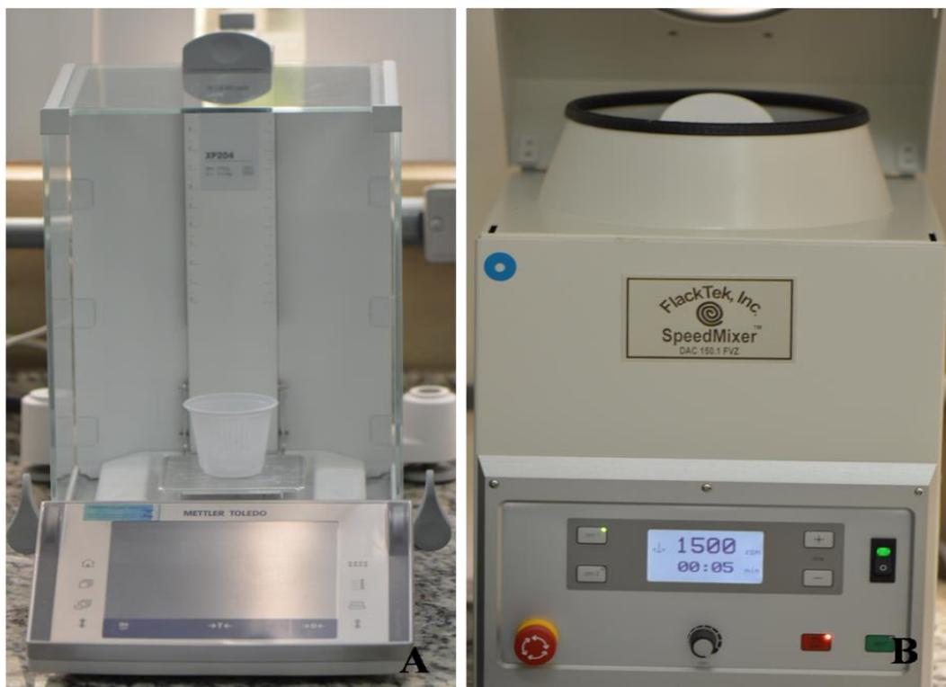
Figura 6 - A) Balança de precisão; B) Agitador Speed Mixer.
