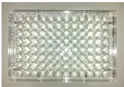
Figura 5 – Placa de 96 poços específica para o ensaio ELISA.
