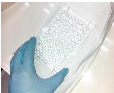
Figura 6 – Secagem da placa com batidas sobre camada de papel absorvente.
