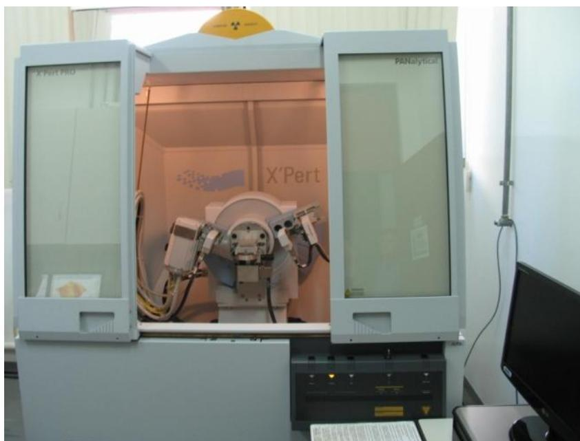
Figura 7 – Difratômetro de raios - X .
