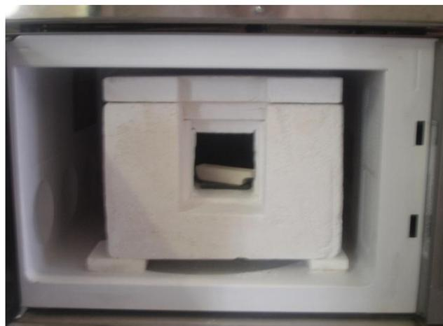
Figura 5 – Amostras dentro de um cadinho para sinterização no forno de micro-ondas.
