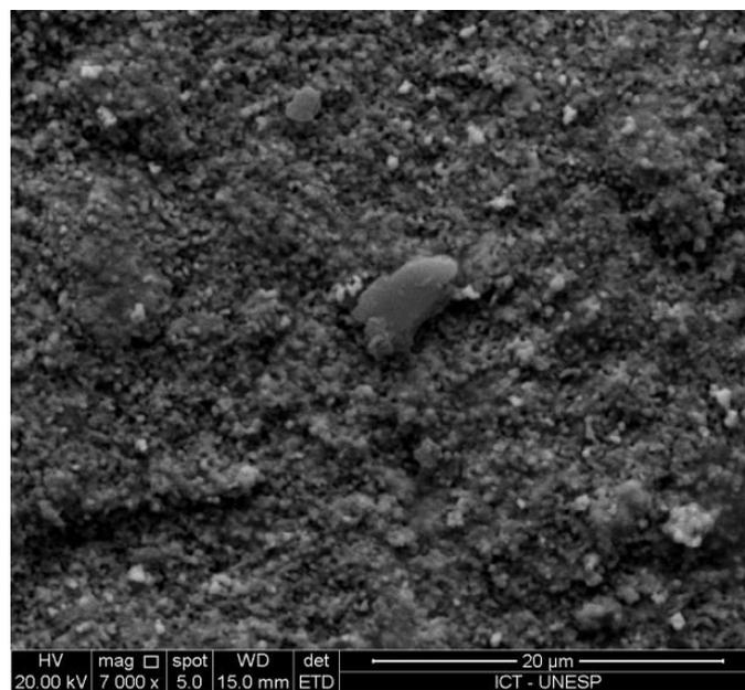
Figura 12 – Análise por MEV grupo IV - Aspecto amorfo da superfície da zircônia indicando ausência de sinterização completa.
