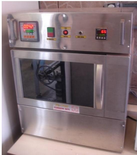
Figura 4 – Forno para sinterização por energia de micro-ondas.
