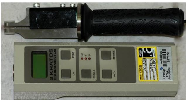
Figura 3 - Dinamômetro modelo IDDK (Kratos – Equipamentos Industriais Ltda, Cotia, São Paulo, Brasil).
