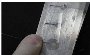
Inserção do material (5mm de diâmetro e 2mm de espessura) e fio de aço na matrix metálica
