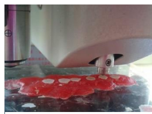
Microdurâmetro Shimadzu Carga estática de 100g Velocidade de 10 segundos
