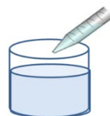
Para cada dosagem foram pipetadas 0,5 ml das soluções DES/RE + 0,5 ml de TISSAB II
