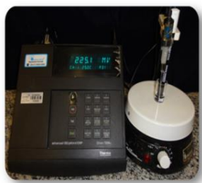
Eletrodo específico combinado para íon fluoreto
