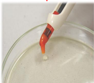
Inserção do material nos poços com auxílio de uma seringa Centrix
