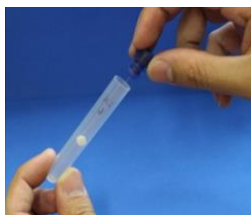
Corpos-de-prova inseridos em tubo de ensaio com 2ml de solução DES/RE
