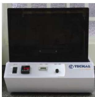
Agitadora: tubos ficaram em agitação constante por 15 dias em 37°C
