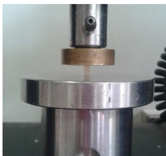
Força aplicada sobre os corpos-de-prova em máquina de ensaios Instron
