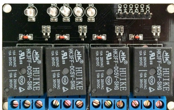
Figura 5. Módulo de hardware com circuito acionador de carga.
