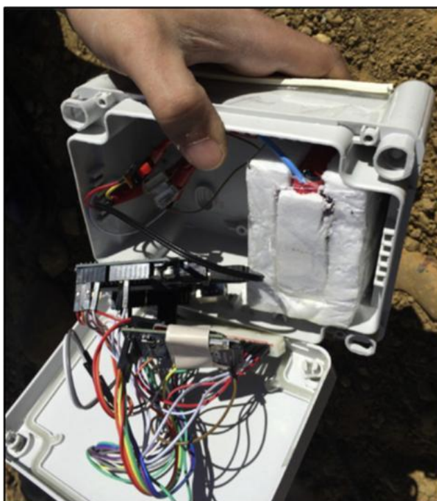
Figura 12: Nó de sensor desenvolvido para monitorar a temperatura e umidade relativa do ar.
