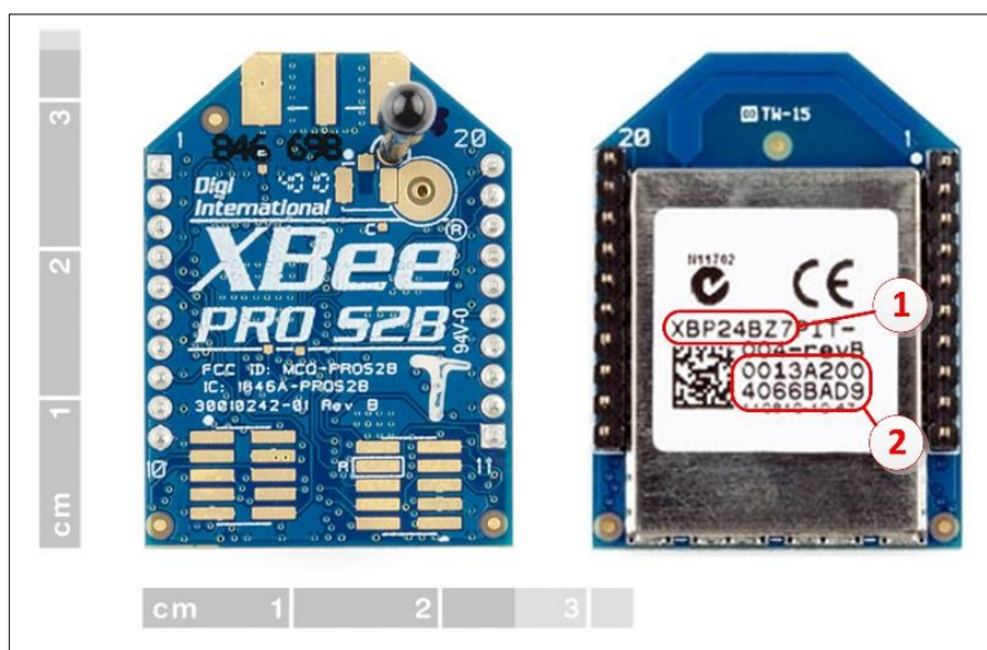
Figura 17: Vista superior e inferior do XBee PRO S2B utilizado durante os testes, o item 1 mostra o modelo do XBee que é o XBP24BZ7, o item 2 mostra o endereço individual do módulo que é 0013A200 4066BAD9.
