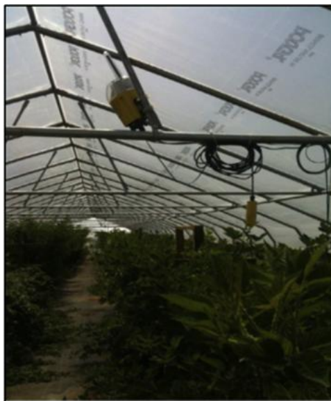
Figura 9: Casa de vegetação e nó da rede de sensor utilizado no estudo para validação das informações de temperatura e umidade relativa do ar.
