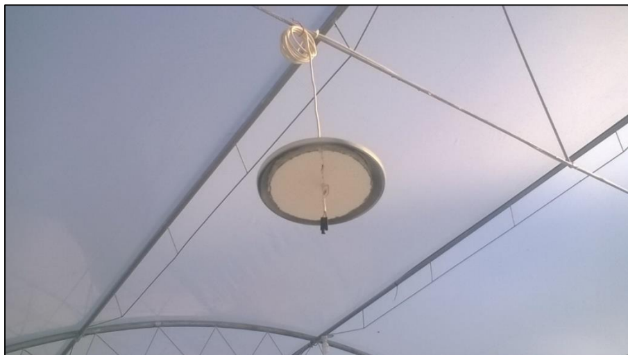
Figura 36: Sensor de temperatura do ar modelo LM35 e abrigo construído com a utilização de prato plástico instalado na parte superior da casa de vegetação.
