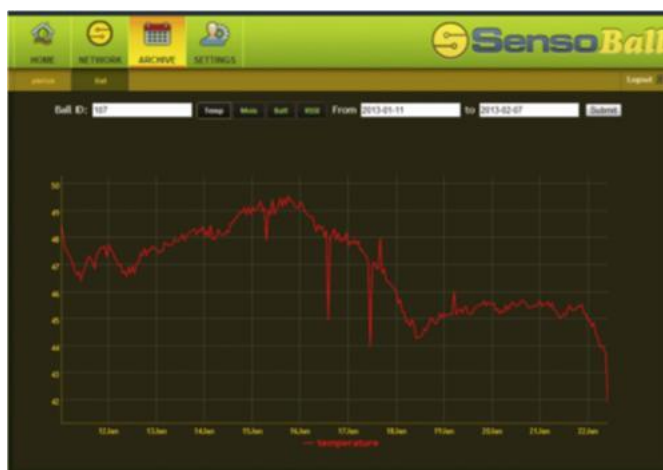
Figura 6: Tela inicial do software de aquisição de dados térmicos, desenvolvido para monitorar em tempo real a temperatura de processos de compostagem.
