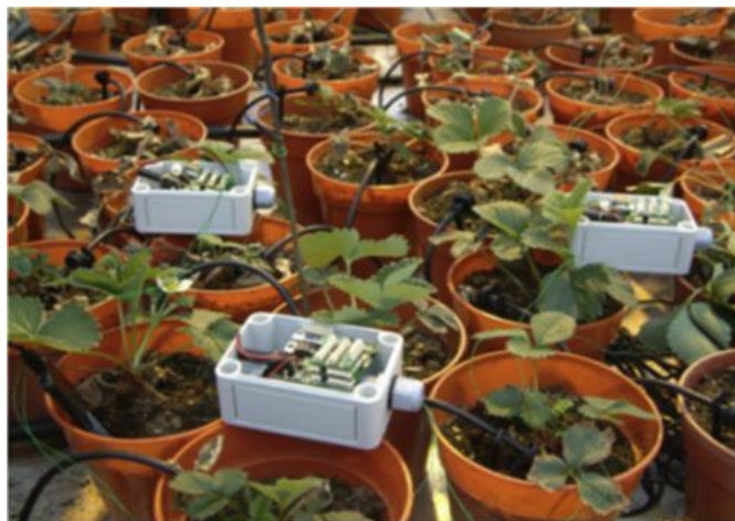
Figura 7: Rede de sem fio com a função de atuador para abertura de válvulas solenoides no cultivo em vaso do morango.
