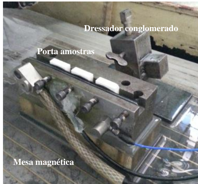
Figura 10 – Dressador conglomerado usado para dressagem do rebolo.
