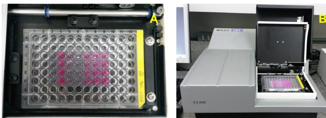
Figura 14 – A) Placa de 96 poços após ação de solução Tris-base 10 mM/l; B) Espectrofotômetro com a placa acoplada para leitura da absorvância.
