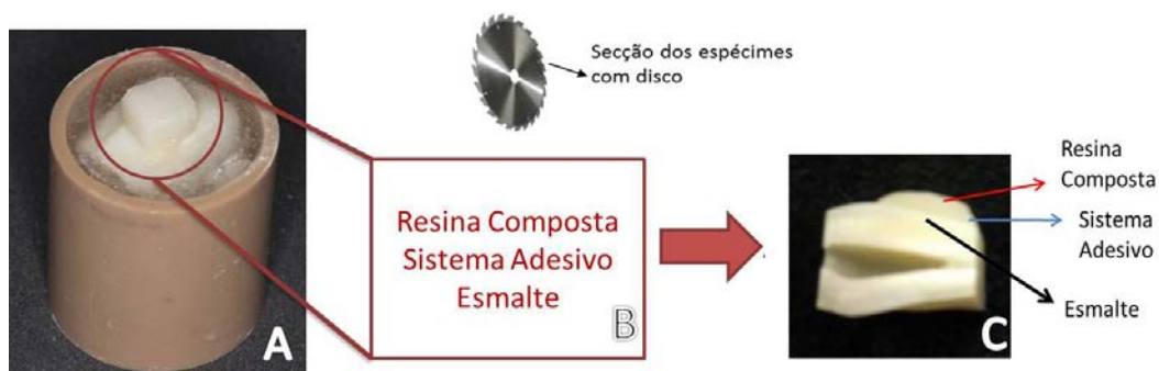
Figura 9 – A) Detalhe do cubo de resina composta; B) Secção do dente perpendicularmente a interface adesiva; C) Uma porção do espécime já seccionado exibindo a resina composta, a área de adesão e o esmalte.
