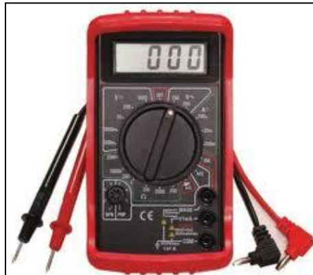
Figura 8 - Multímetro utilizado para verificar a capacidade dos filmes de recobrimento de isolar o Ti-6Al-4V.
