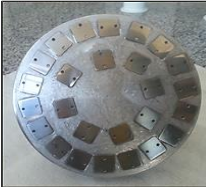
Figura 1- Porta amostra contendo os corpos de prova polidos com lixa d'água com granulometria de 1200.
