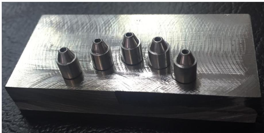
Figura 18 – Dispositivo desenvolvido para testes de carga máxima à fratura.
