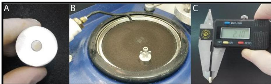
Figura 11 - Polimento dos espécimes na politriz. A) Posicionamento do espécime na matriz metálica; B) Polimento do espécime; C) Espessura final conferida com paquímetro digital.
