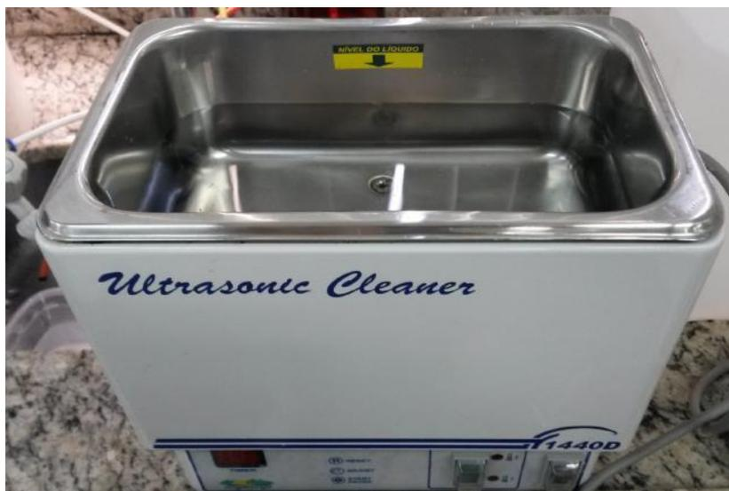
Figura 12 – Ultrassom utilizado para limpeza dos espécimes
