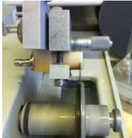
Figura 39 - Corte dos discos de cerâmica feldspática.
