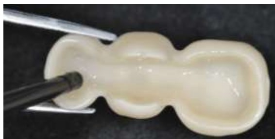
Figura 14 - Tratamento de superfície na cerâmica de cobertura com ácido fluorídrico 5%.
