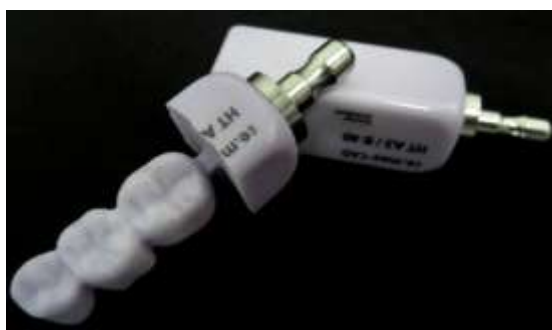
Figura 12 - Cerâmica de cobertura CAD-on Ivoclar Vivadent usinada no Cerec 3.8.
