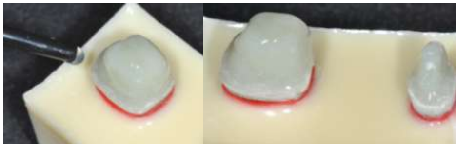
Figura 15 - Aplicação do ácido fluorídrico 5% nos pilares de G10.
