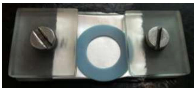
Figura 25 - Anel de plástico usado como dispositivo para confecção dos discos de VM9.
