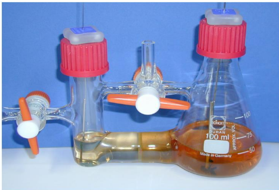
Figura 7: Célula eletroquímica utilizada na síntese de condutores orgânicos. É possível observar a formação de cristais no eletrodo direito [23].
