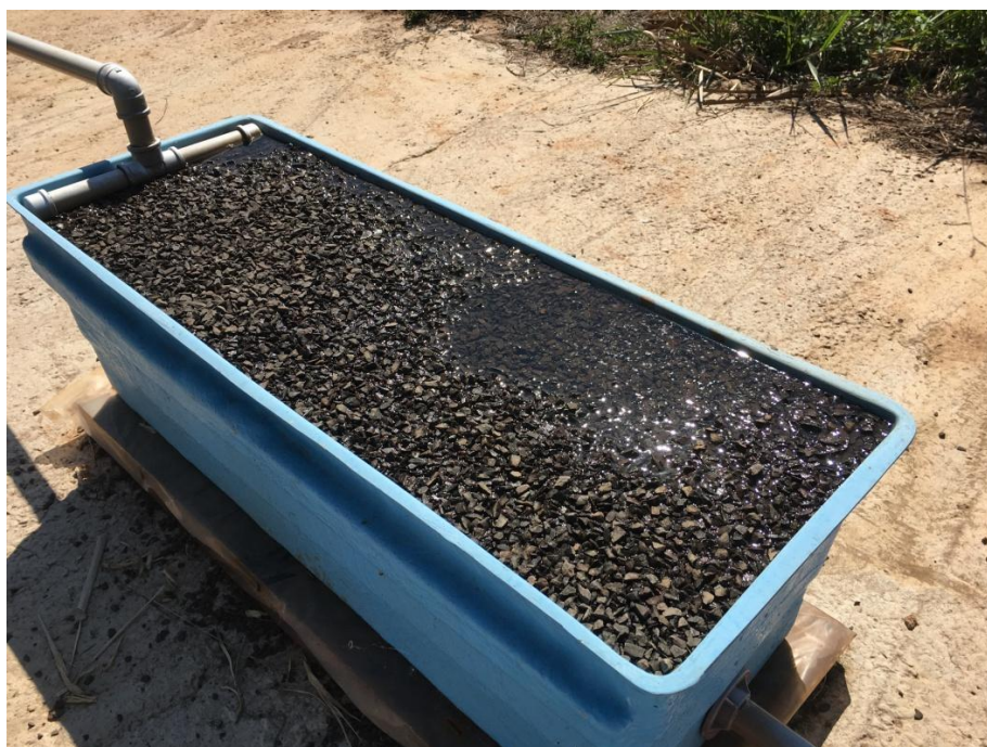
Figura 25 - Escoamento superficial do efluente na primeira caixa d'água do alagado construído sem cultivo de macrófitas (Alagado 1).
