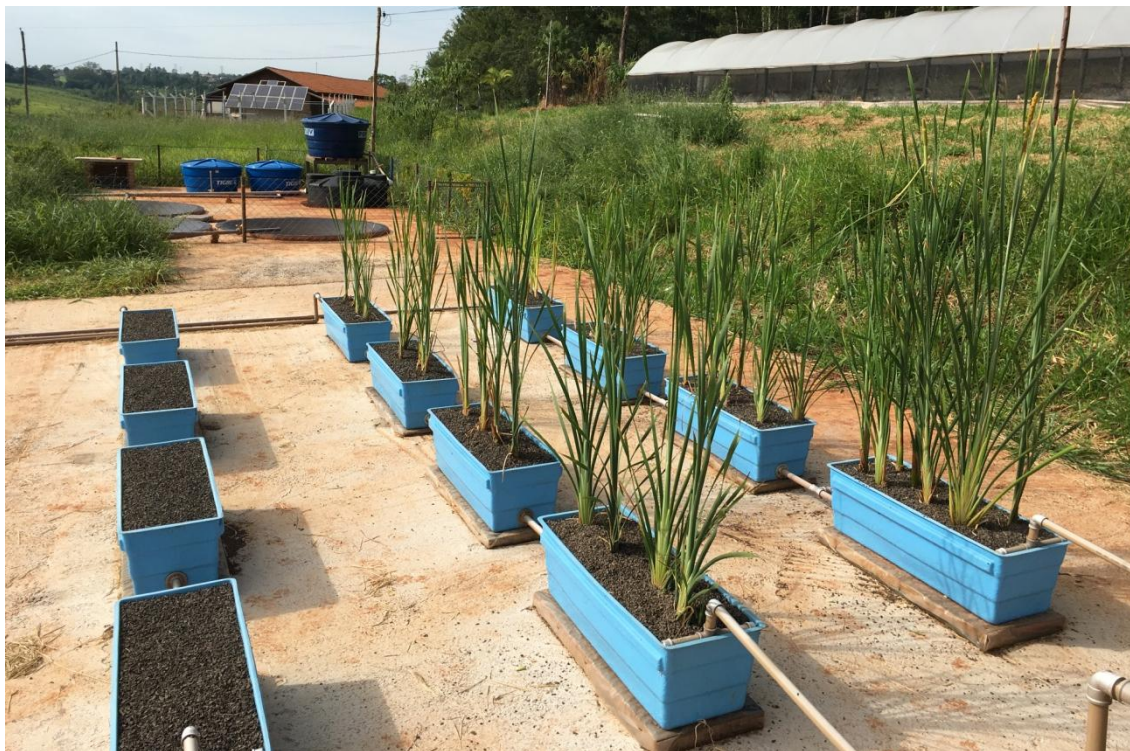
Figura 8 – Leitões de alagados construídos do sistema de tratamento desenvolvido.
