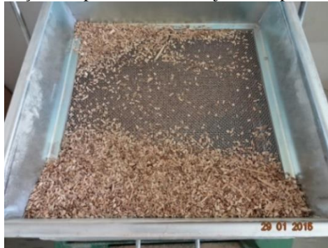
Figura 4.23: Seleção das partículas em conjunto de peneiras com agitador.
