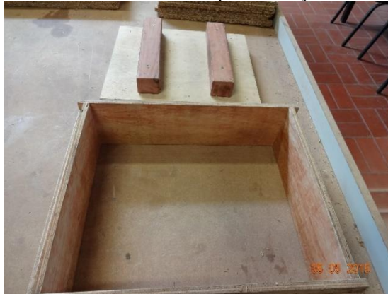
Figura 4.18: Caixa em madeira para formação dos colchões
