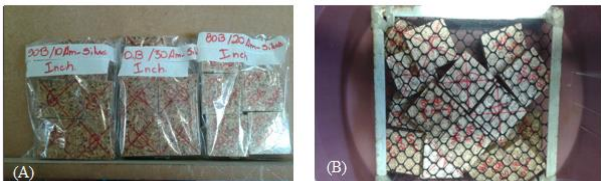
Figura 4.38: Corpos de prova medidos e pesados para ensaio (A) e Submersos em água para determinação do inchamento em espessura (B)
