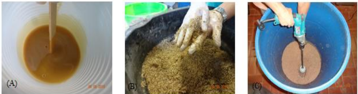
Figura 4.26: Adição do Poliól e Pré- Polímero (A) Mistura dos componentes manualmente (B) e Mistura mecânica dos componentes.
