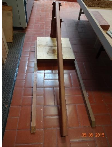
Figura 4.16: Prensa manual em madeira
