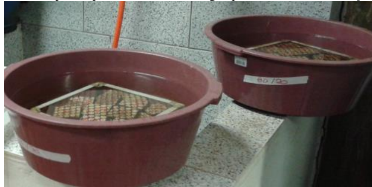
Figura 4.37: Corpos de prova submersos em água para determinar a absorção de água
