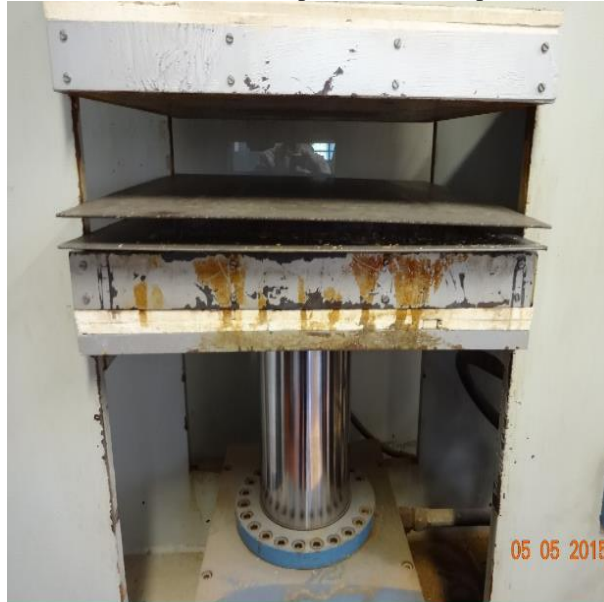
Figura 4.30: Colchão entre chapas metálica em prensa hidráulica
