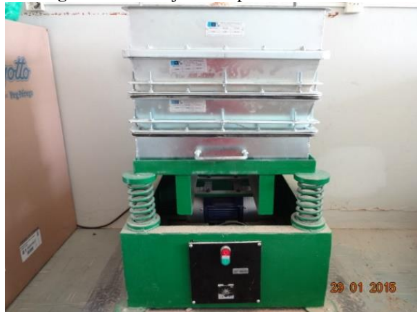
Figura 4.17: Conjunto de peneiras vibratórias.
