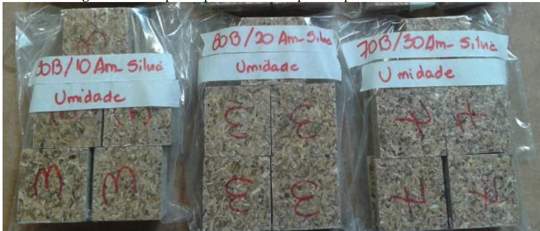
Figura 4.36: Corpos de prova medidos e pesados para ensaio de umidade.
