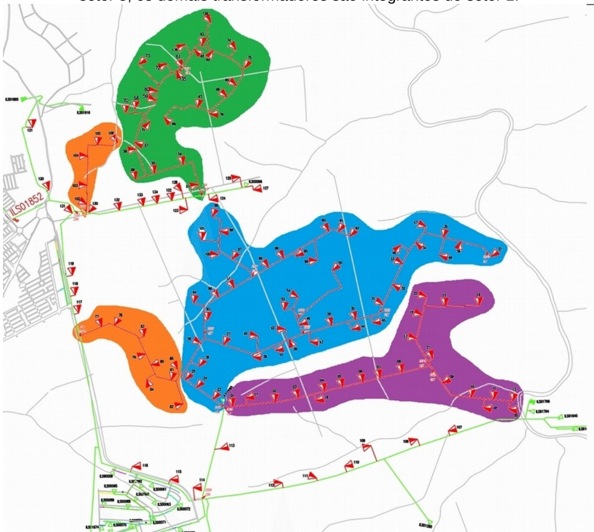
Figura 23 - Divisão em setores da planta elétrica do assentamento Estrela da Ilha. Em verde temos o setor 2, em laranja o setor 3, em azul o setor 4, em roxo o setor 5, os demais transformadores são integrantes do setor 1.
