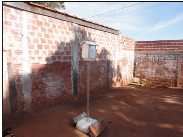
Figura 6 - Abrigo meteorológico instalado na lateral do terreno - ponto fixo 2.
