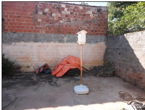
Figura 4 - Abrigo meteorológico instalado nos fundos do terreno - ponto fixo 1.
