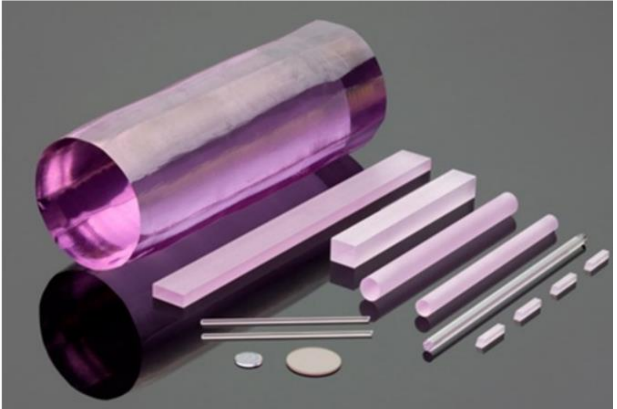
Figura 4 – Cristais Nd:YAG utilizados em lasers de estado sólido
