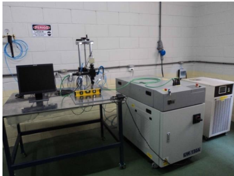
Figura 9 – Sistema laser Nd:YAG pulsado, modelo UW-150A United Winners, montado no Laboratório de Soldagem
