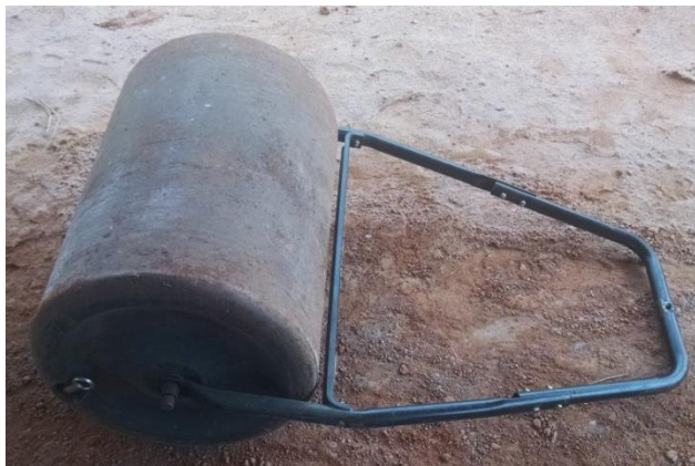
Figura 12. Rolo compactador utilizado para aumentar a aderência dos tapetes de grama com a base.
