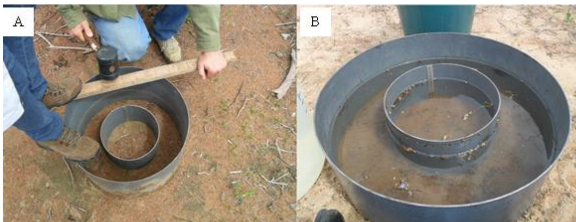
Figura 14. Teste de infiltração de água no solo pela metodologia dos anéis concêntricos, (A) anéis sendo fincados ao solo e (B) anéis preenchidos com água, teste em andamento.
