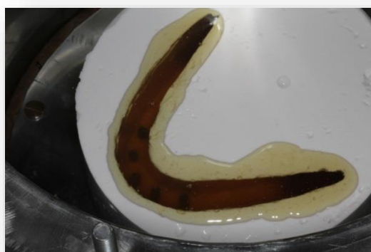
Figura 13 - Vazamento da resina fotoelástica PL-2
