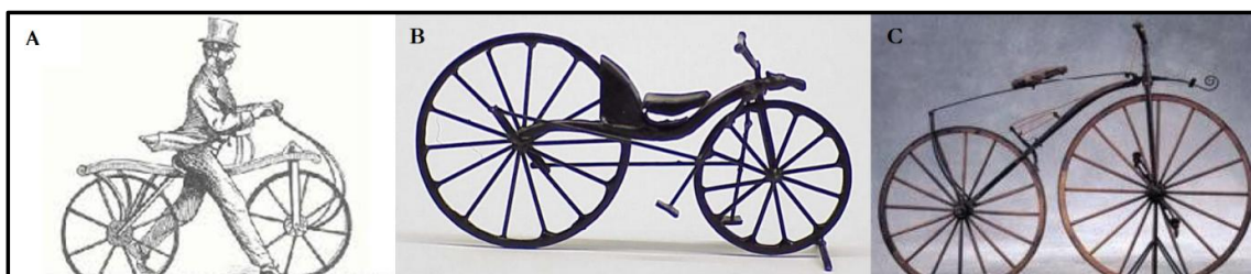
Figura 1 - Três primeiros modelos de bicicleta. A) Draisiana - Karl Drais; B) Bicicleta com pedal acíclico - Scottish Macmillan; C) Bicicleta com pedal cíclico - Pierre Michaux.
