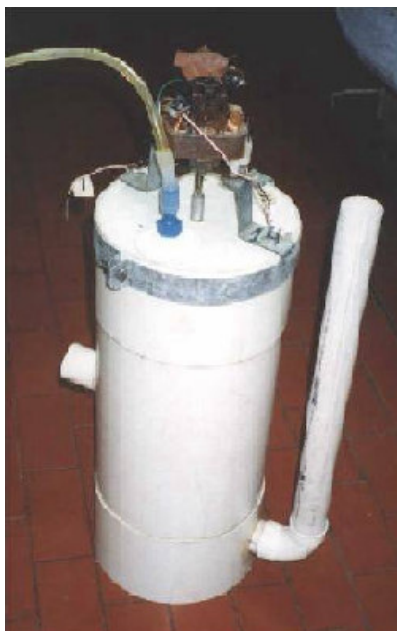
FIGURA 1. Biodigestor de bancada, com 14 L de capacidade, usado no experimento.
