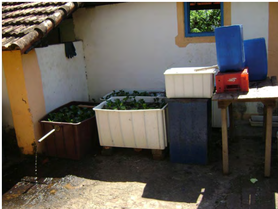
Figura 2: Sistema piloto de tratamento do efluente de curtume com escama e aguapé.
