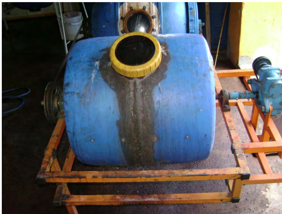
Figura 1: Fulão utilizado no processamento de peles de tilápia (capacidade de 9-10 kg de pele).
