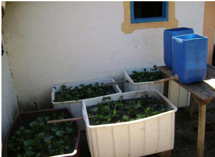
Figura 4: Sistema piloto de tratamento do efluente de curtume com aguapé.
