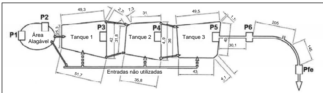
Figura 9. Esquema do pesque-pague do orfanato Lar do Caminho, onde: P 1 -P fe = pontos de coleta. Todas as medidas estão em metros (m).
