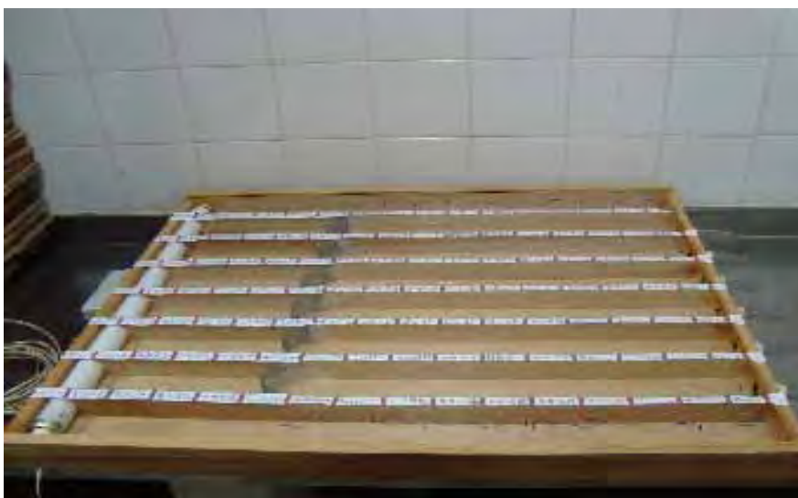
Figura II: Caixa-gaveta com raias para os testes de locomoção.
