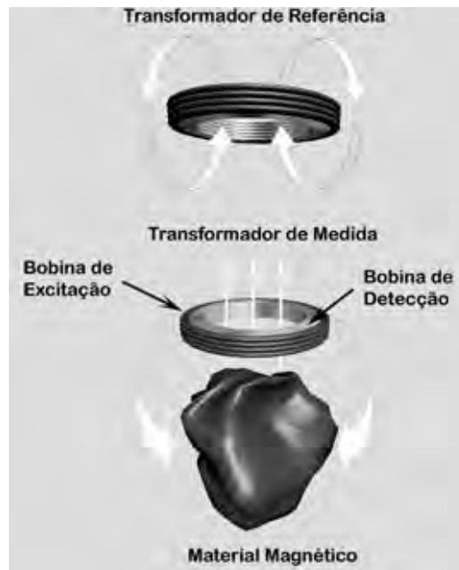
Figura 2. Esquema de funcionamento do sensor magnético. A bobina de excitação induz fluxo magnético na bobina de detecção que ao ser aproximada do material magnético promove um desbalanceamento no fluxo magnético entre as bobinas, permitindo seu monitoramento.
